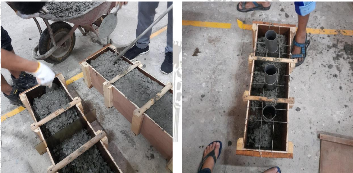
Gambar 5. Proses penuangan beton segar pada bekisting (a) Benda uji beton normal dan benda uji dengan retak; (b) Benda uji intrusi air (dengan lubang)
