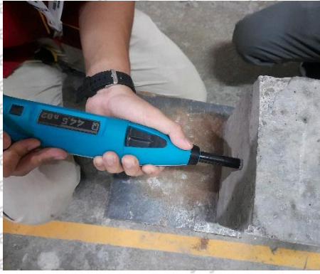
Gambar 4.6 Uji Kuat Tekan Hammer Test
