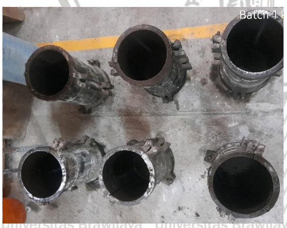
Gambar 3. Persiapan bekisting/cetakan silinder (mengolesi oli pada permukaan dalam)
