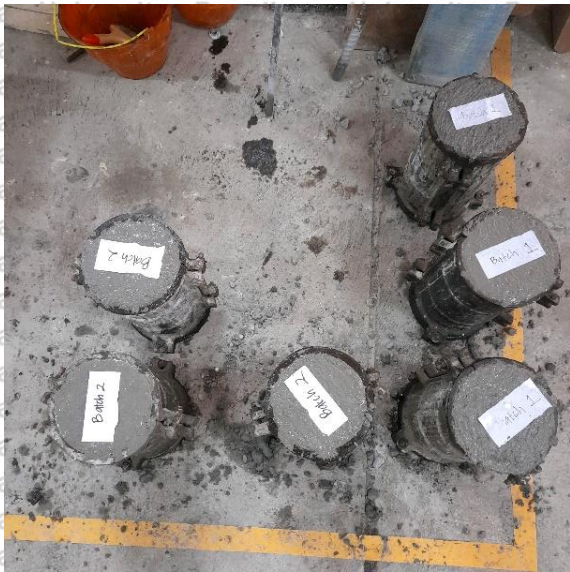
Gambar 8. Benda uji pada bekisting/cetakan silinder
