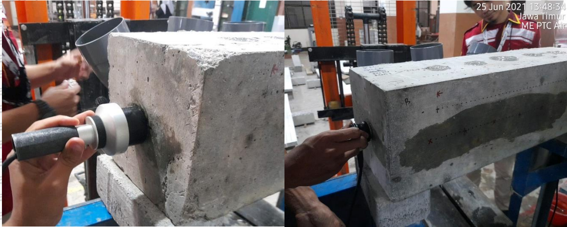
Gambar 20. Pengujian UPV benda uji dengan lubang (kondisi lubang berisi air)
