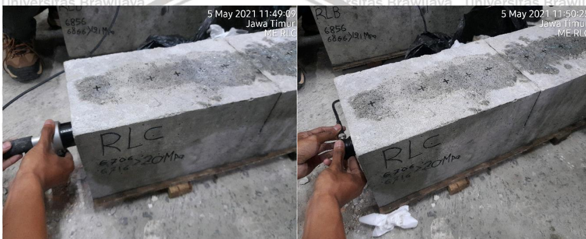
Gambar 18. Pengujian UPV benda uji keretakan
