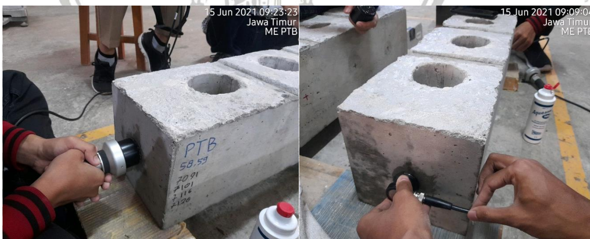
Gambar 19. Pengujian UPV benda uji intrusi air (kondisi lubang tanpa air)
