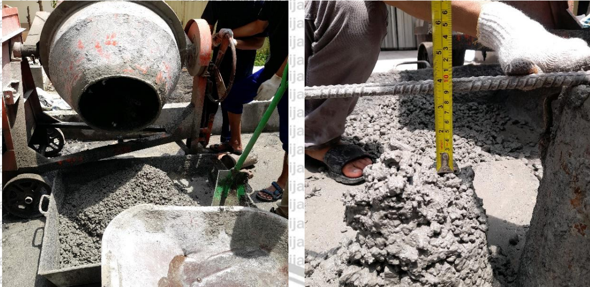
Gambar 4. (a) Pengadukan campuran beton menggunakan concrete mixer ; (b) Uji Slump
