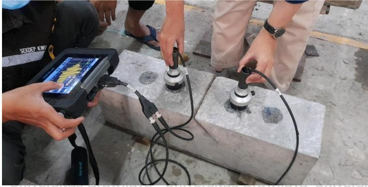
Gambar 4.12 Pengujian UPV *Crack Depth Method*
