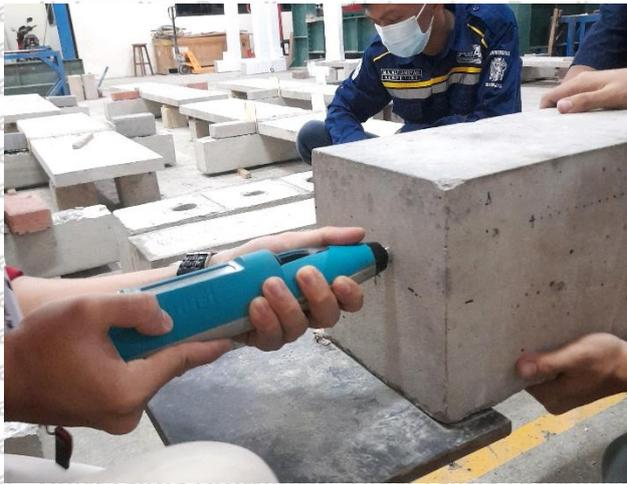
Gambar 4. 4 Pengujian kuat tekan beton dengan *hammer test*
