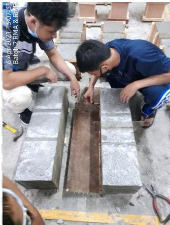
Gambar 6. Proses pelepasan bekisting
