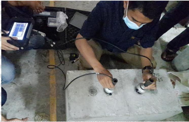
Gambar 3.7 Pengujian UPV *Indirect Method*
