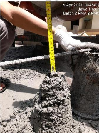
Gambar 3. Pengujian *Slump*
