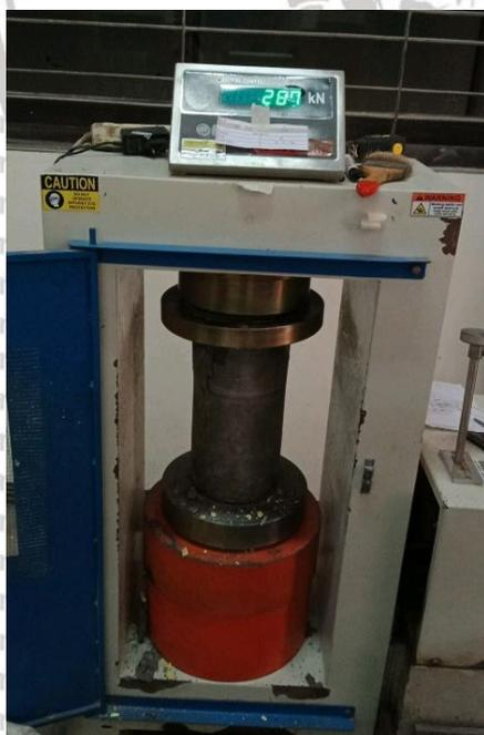
Gambar 4. 3 Pengujian kuat tekan beton dengan *compressive test*
