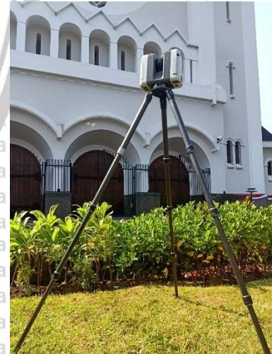
Gambar 3.5 Perekaman dengan kamera laser scanner
