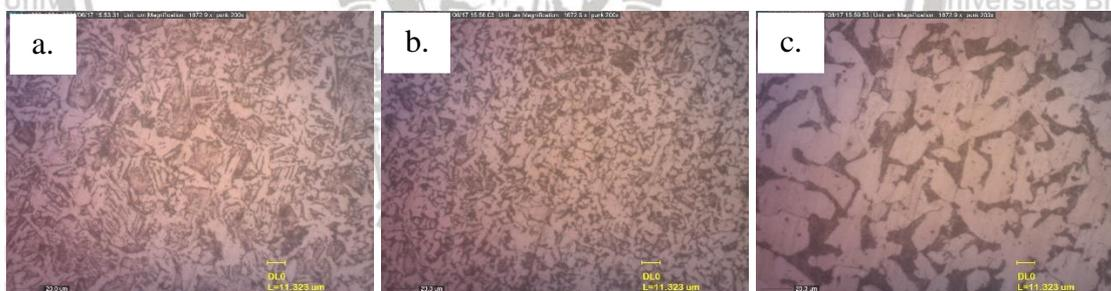
Gambar 4.6 Hasil Pengujian Mikrostruktur Pada Sambungan Las SMAW Pipa ASTM A 106 Grade B, Daerah Las yaitu: a. *Weld Metal*, b. *Heat Affected Zone (HAZ)*, c. *Base Metal*
