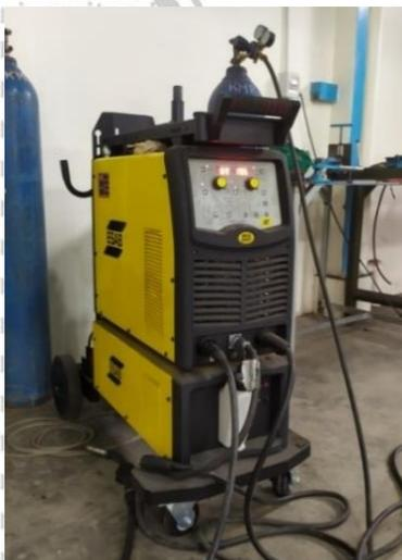
Gambar 3.1 Mesin Las ESAB MIG *Fabricator* 500P
