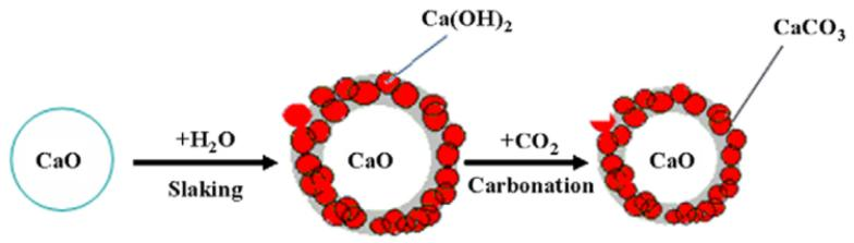
**Gambar 3.3.** Sintesis PCC melalui metode karbonasi [9].
