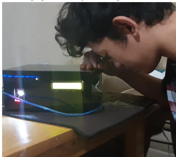
Gambar 6.2 Pengambilan nilai Suhu Tubuh dengan Sensor MLX 90614
