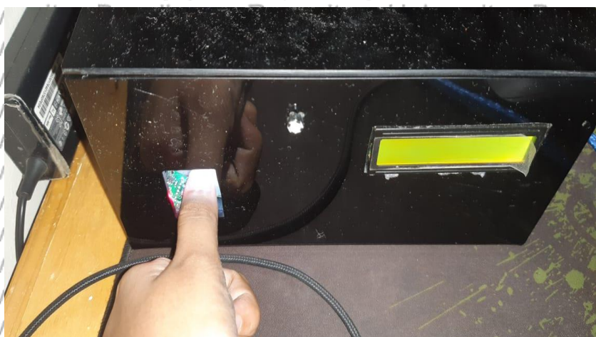
Gambar 6.3 Pengambilan nilai Spo2 dengan Sensor MAX 30100
