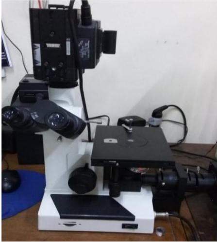
Gambar 3.6 Mikroskop logam
