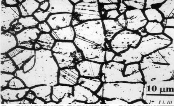
Gambar 2.10 Korosi batas butir pada stainless steel tersensitisasi
