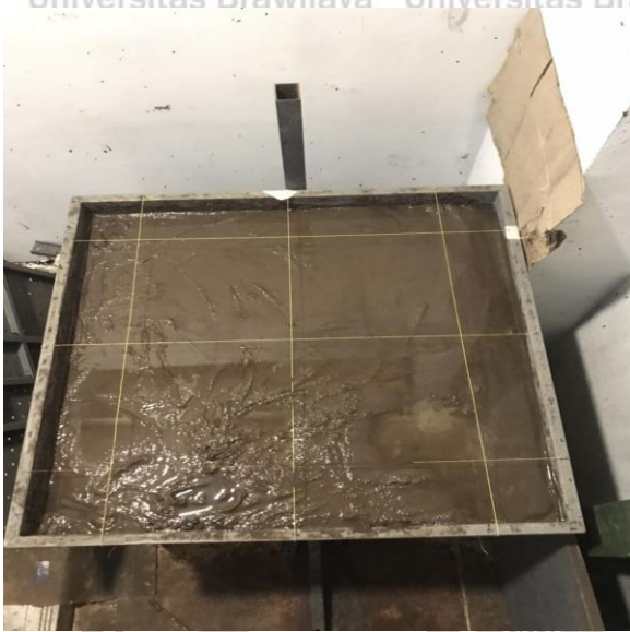
Gambar 3.4 Alat Uji dan Box Konsolidasi 60x60x55 cm 3
