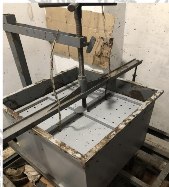
Gambar 4. Pemasangan Plat dan Lengan
