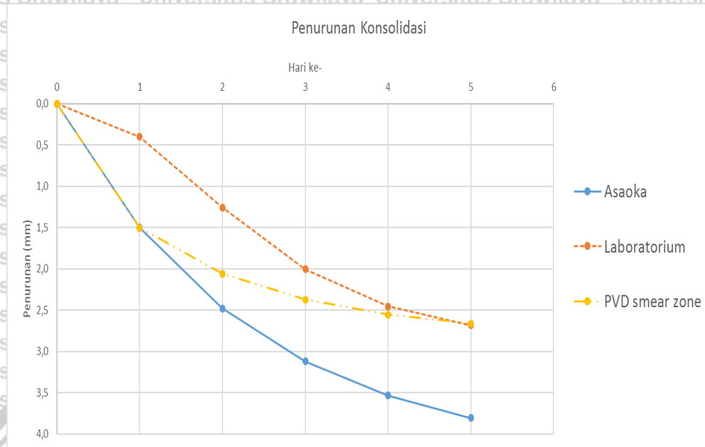
Gambar 4.7 Perbandingan Nilai Penurunan Terhadap Waktu Konsolidasi pada Kedalaman PVD 25 cm Pola Segiempat
