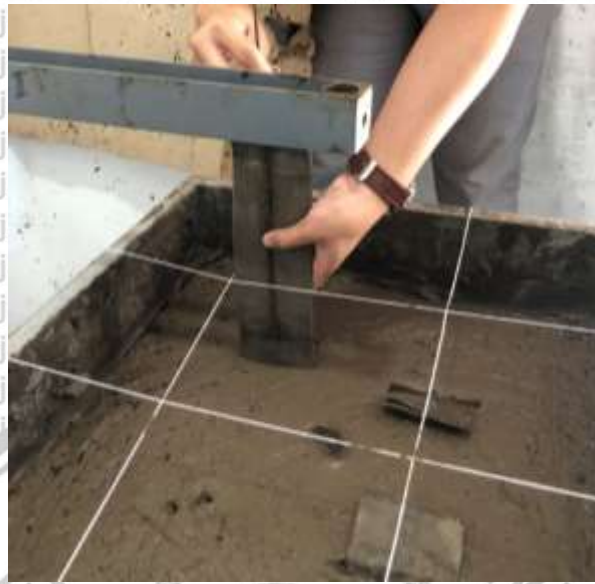
Tampak atas pemasangan pvd pola segiempat dengan jarak 20cm kedalamannya 25cm
