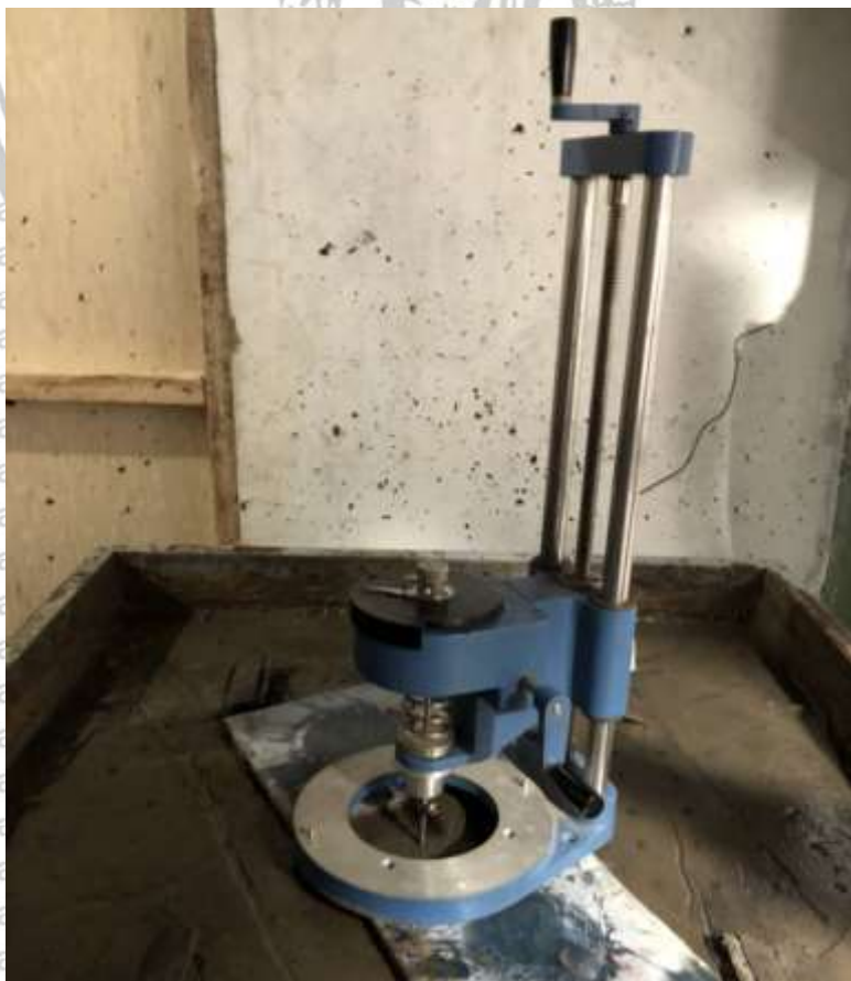
Pengujian Vaneshear pada sampel tanah
