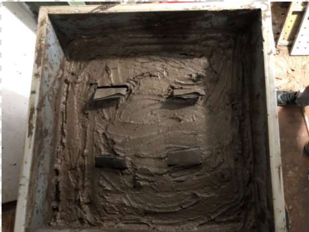
Tampak atas pemasangan pvd pola segiempat dengan jarak 20cm kedalamannya 25cm
