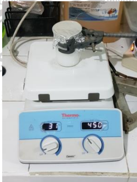
Gambar lampiran 1.1 Proses Sintesis \text{CaSiO}_3 Menggunakan Magnetic Stirrer
