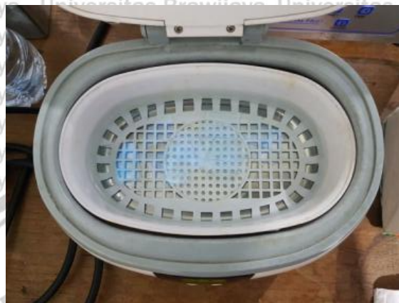
Gambar lampiran 1.8 Perendaman Kaca TCO Menggunakan Ultrasonic Cleaner
