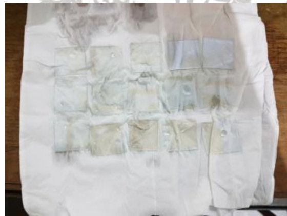
Gambar lampiran 1.9 Kaca TCO Setelah Direndam Menggunakan Ultrasonic Cleaner
