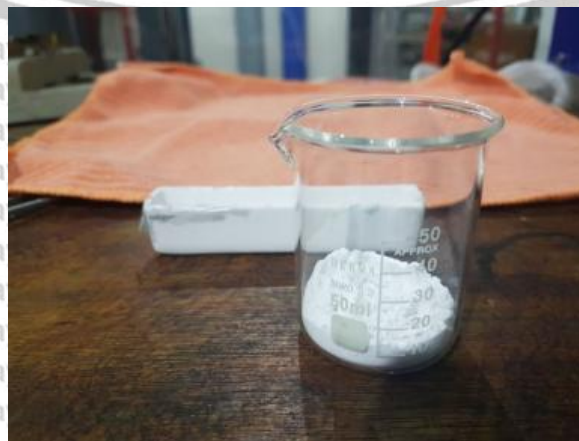
Gambar lampiran 1.7 \text{CaSiO}_3 Setelah Proses Firing Menggunakan Furnance
