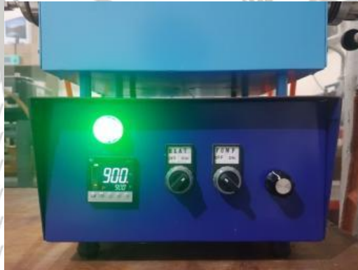
Gambar lampiran 1.6 Proses Firing Menggunakan Furnance
