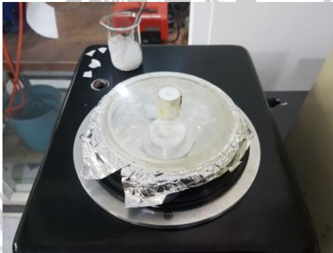
Gambar lampiran 1.14 Proses Pelapisan Perovskite
