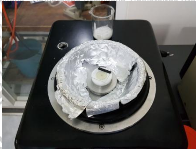
Gambar lampiran 1.13 Proses Pelapisan Pasta TiO 2
