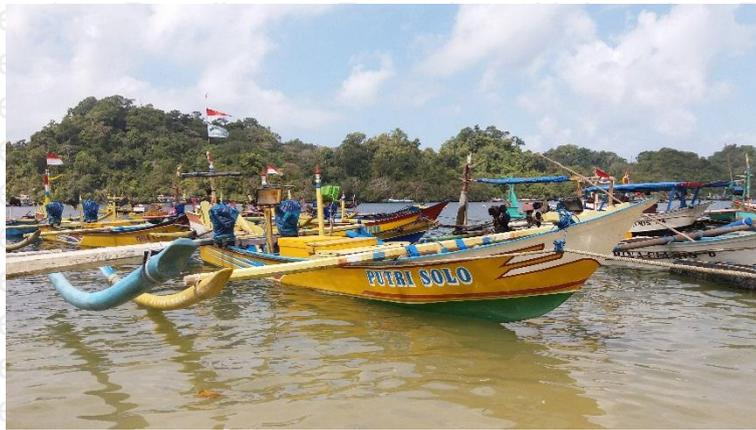
**Gambar 7.** Kapal Putri Solo. Kapal yang digunakan oleh nelayan Jukung (Speed) di Sendang biru. Kapal dengan kecepatan 1 GT. Menggunakan alat tangkap pancing tonda dan pancing ulur untuk pengoperasiannya.
