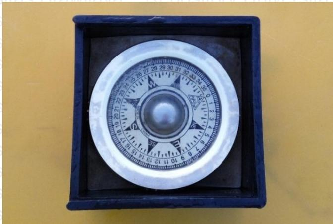
**Gambar 27.** Kompas. Kompas memiliki fungsi untuk menetapkan arah haluan kapal dan juga untuk membaring suatu target sasaran. Kompas juga sangat membantu dalam menentukan daerah penangkapan ikan seperti pada rumpon
