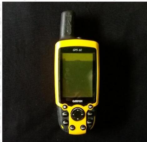
**Gambar 28.** GPS. Gps digunakan nelayan unruk mengetahui koordinat lintang bujur, arah, kecepatan, posisi di laut, menentukan rute perjalanan, menandai tempat – tempat penting seperti letak rumpon, tempat yang dangkal dan sebagainya.
