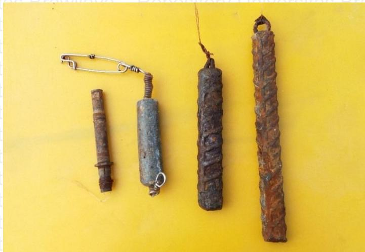
**Gambar 12.** Pemberat. Pemberat merupakan benda yang digunakan untuk menenggelamkan suatu alat tangkap di perairan. Berikut merupakan pemberat yang digunakan oleh nelayan kapal Jukung (Speed).
