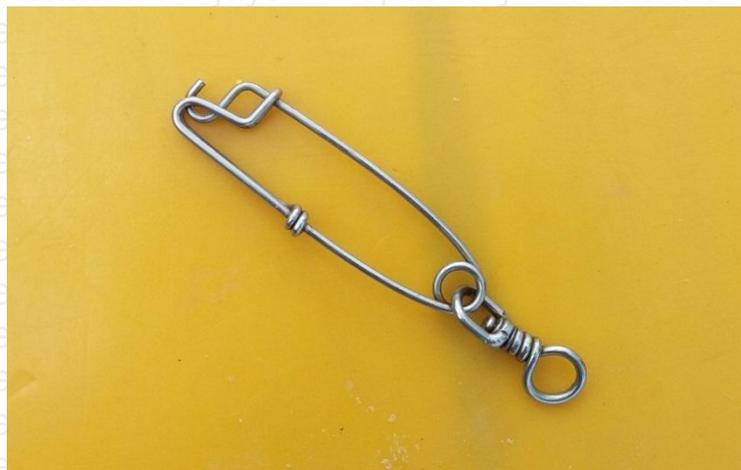
**Gambar 20.** Snap. Snap Snap atau peniti mempunyai fungsi membantu memudahkan menyambung atau memutus rangkaian rawai atau kail dengan tali utama.
