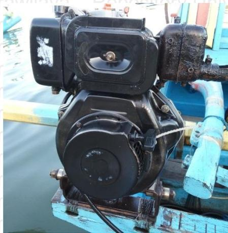
**Gambar 9.** Mesin Kapal. Mesin kapal dari kapal Putri Solo memiliki mesin sebanyak 2 buah dengan merek mesin Kipor Model KD 188FA Engine, sehingga kapal ini membutuhkan bahan bakar berupa solar.
