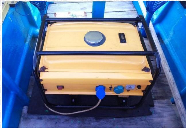
**Gambar 24.** Genset. Genset merupakan perangkat yang menghasilkan daya listrik sehingga dapat membantu proses penerangan pada saat oprasi penangkapan dan berjalannya mesin kapal.
