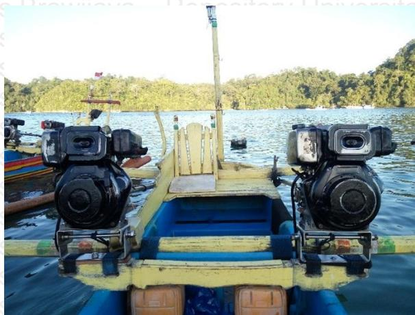
**Gambar 6.** Mesin Kapal. Mesin kapal dari kapal Viola Putri memiliki mesin sebanyak 2 buah dengan merek mesin Kipor Model KD 188FA Engine, sehingga kapal ini membutuhkan bahan bakar berupa solar.
