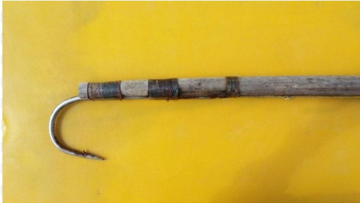
**Gambar 26.** Ganco. Ganco digunakan pada kapal jukung (Speed) agar mempermudah saat penarikan ikan ke atas kapal.
