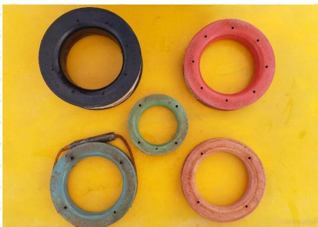
**Gambar 14.** Gulungan. Digunakan untuk menggulung tali pada alat tangkap kapal jukung (Speed). Agar lebih mudah menurunkan alat tangkap.
