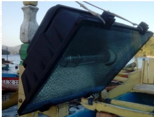
**Gambar 25.** Lampu. Lampu digunakan pada kapl jukung (Speed) untuk membantu penerangan pada saat pengoprasian alat tangkap.
