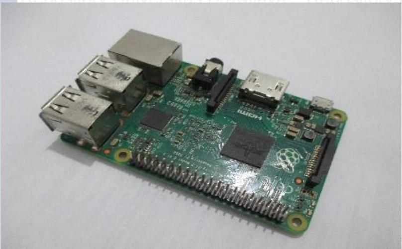
Gambar 2.6 Raspberry Pi-2 model B
