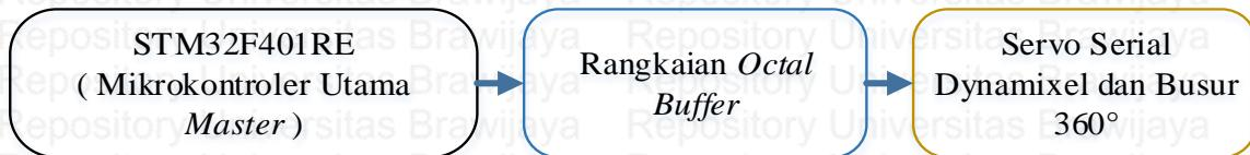
Gambar 3.15 Skema pengujian sudut servo serial dynamixel
