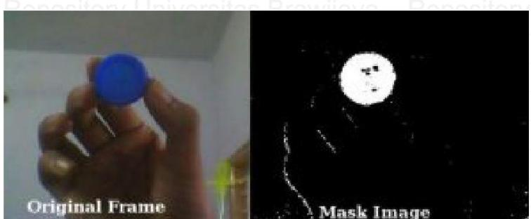
Gambar 2.3 Deteksi warna dengan memisahkan satu warna dengan warna lainnya
