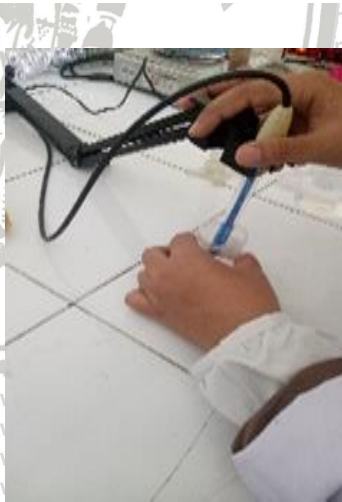
Pengujian pH dengan pH meter
