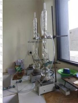
Peralatan yang digunakan untuk analisis kadar lemak terdapat eksikator, kertas saring, kapas, benang kasar serta soxhlet.
