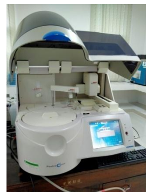
Gambar. Alat biokimia analyzer (Pentra C200 ® ) untuk mengukur kadar kolesterol
