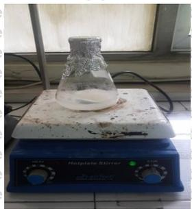
Pelarutan NaOH kedalam metil asetat menggunakan magnetic stirrer
