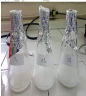
NaOH yang larut dalam metil asetat
