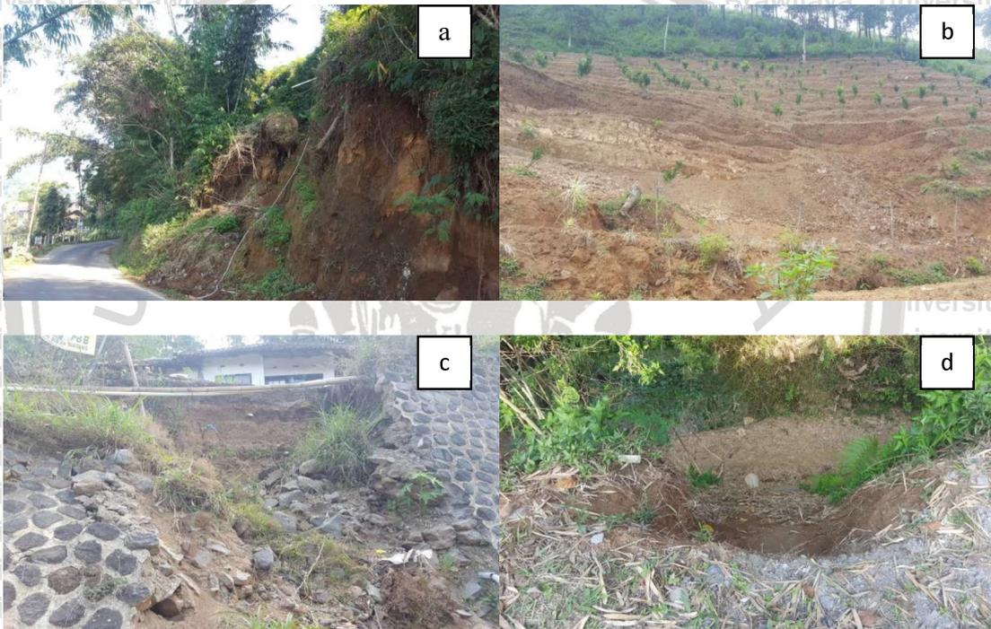
Gambar 13. Tipe Longsor di Lapangan (a) longsor rotasi, (b) longsor rotasi (c) longsor translasi, dan (d) Aliran (Flow)
