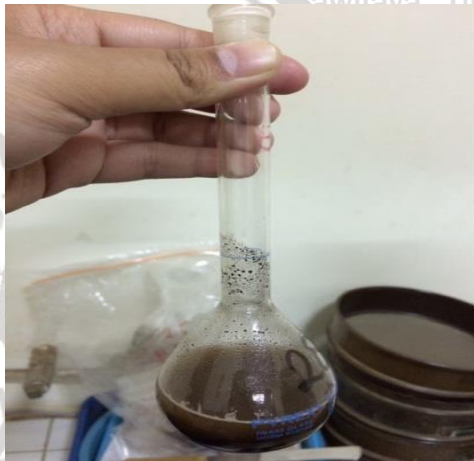
Menimbang Labu + Aquades + Sampel Tanah
