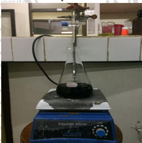
Titrasi menggunakan FeSO_4
