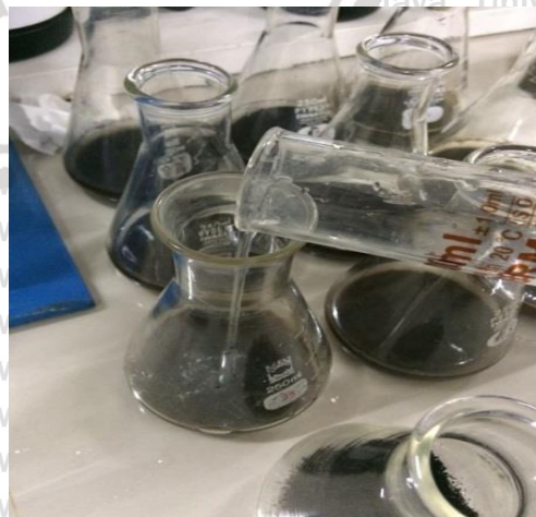
Menambahkan Sampel Tanah + Peroksida
