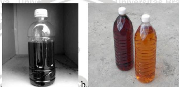
Gambar 7. *Wood vinegar* yang belum dilakukan penyulingan (*raw wood vinegar*) (a) (Wessapan *et al.*, 2014) serta perbandingan *wood vinegar* yang belum dilakukan penyulingan (kiri) dan telah dilakukan penyulingan (kanan) (b) (Chan *et al.*, 2012)
