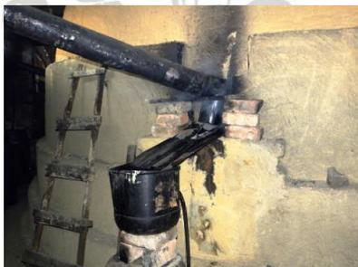
Gambar 5. Asap hasil pembakaran dikeluarkan dan dikondensasi dengan cerobong besi lalu ditampung di dalam drum plastik dalam bentuk *wood vinegar* (Chan *et al.*, 2012)
