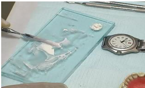
Gambar 2.3 Manipulasi Dilakukan Dengan Gerakan Memutar dari Spatula pada Area yang Cukup Luas
