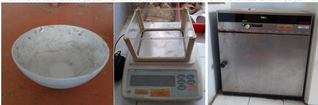
Gambar 3.2 Alat yang digunakan untuk menghitung kadar air
