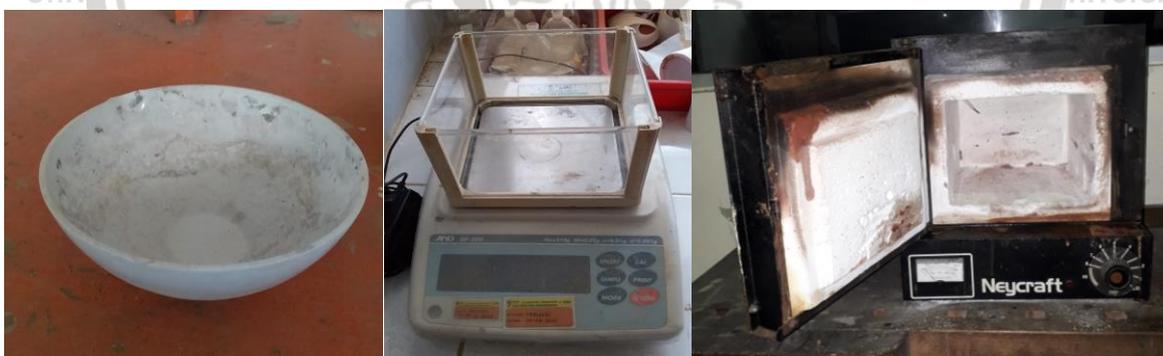
Gambar 3.3 Alat yang digunakan untuk menghitung kadar abu
