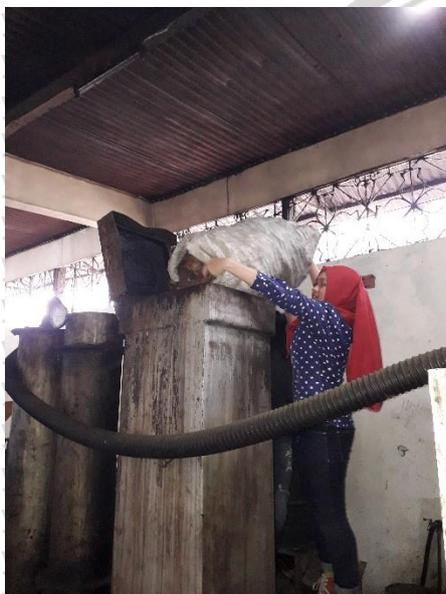
Gambar 4.3 Proses memasukkan cangkang bunga pinus ke dalam alat *slow pyrolysis*
