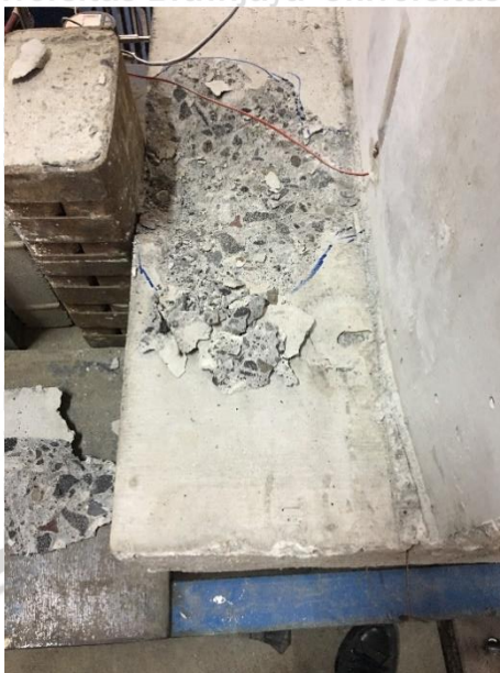
Gambar 4.6 pecah yang terjadi pada bagian tumpuan benda uji
