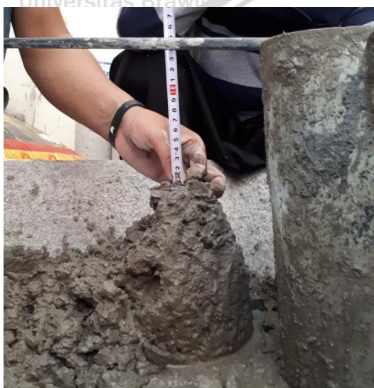
Gambar 4.2 Uji Slump Beton.
