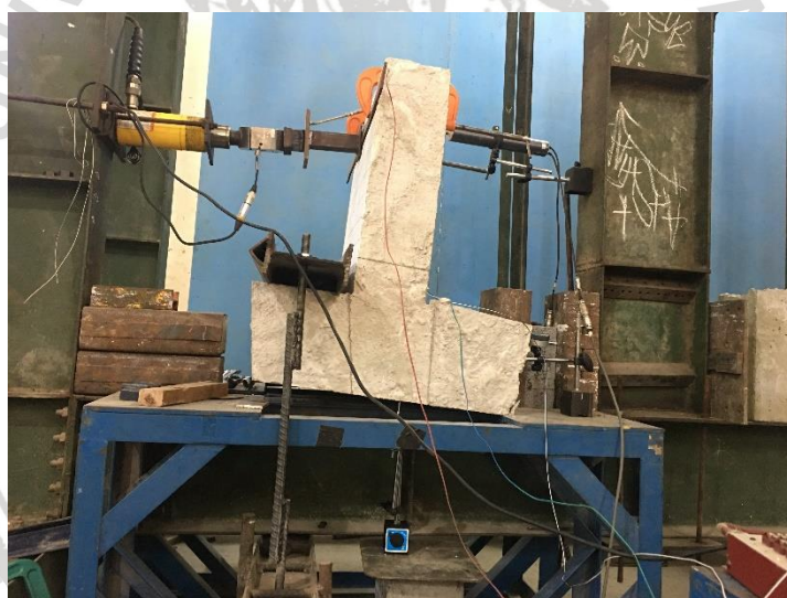
Gambar 4.5 benda uji dengan dimensi kurang sempurna yang terangkat akibat klem tidak mampu menahan gaya pada benda uji
