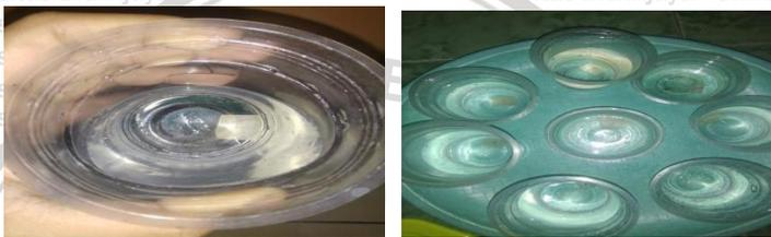
**Gambar 9** Kondisi sampel saat uji ketahanan air
