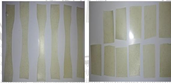
**Gambar 3** Contoh sampel dengan penguat  $\text{SiO}_2$  0,5 gram
