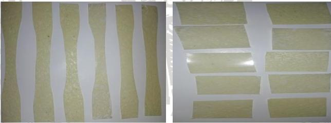
**Gambar 6** Contoh sampel dengan penguat SiO<sub>2</sub> 1,25 gram
