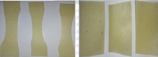
**Gambar 7** Contoh sampel dengan penguat  $\text{SiO}_2$  1,5 gram
