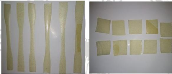
**Gambar 2** Contoh sampel dengan penguat  $\text{SiO}_2$  0,25 gram
