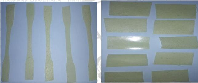
**Gambar 5** Contoh sampel dengan penguat SiO<sub>2</sub> 1 gram
