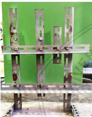
Gambar 3.4 Dudukan spesimen *sandblasting*
