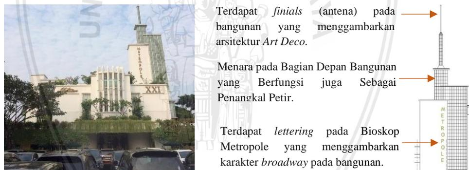
Gambar 4. 56 Deskripsi dinding eksterior
