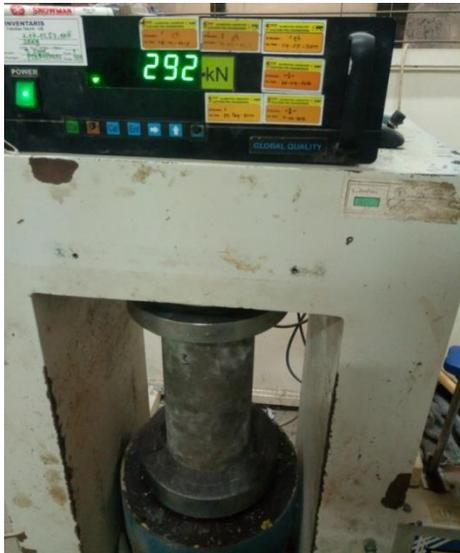
Gambar 5. 1 Uji kuat tekan silinder beton
