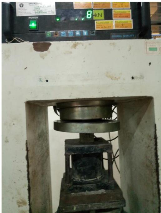
Gambar 5. 2 Uji kuat tekan spesi mortar
