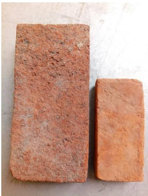
Gambar 5. 3 Perbandingan ukuran bata normal dan bata terskala
