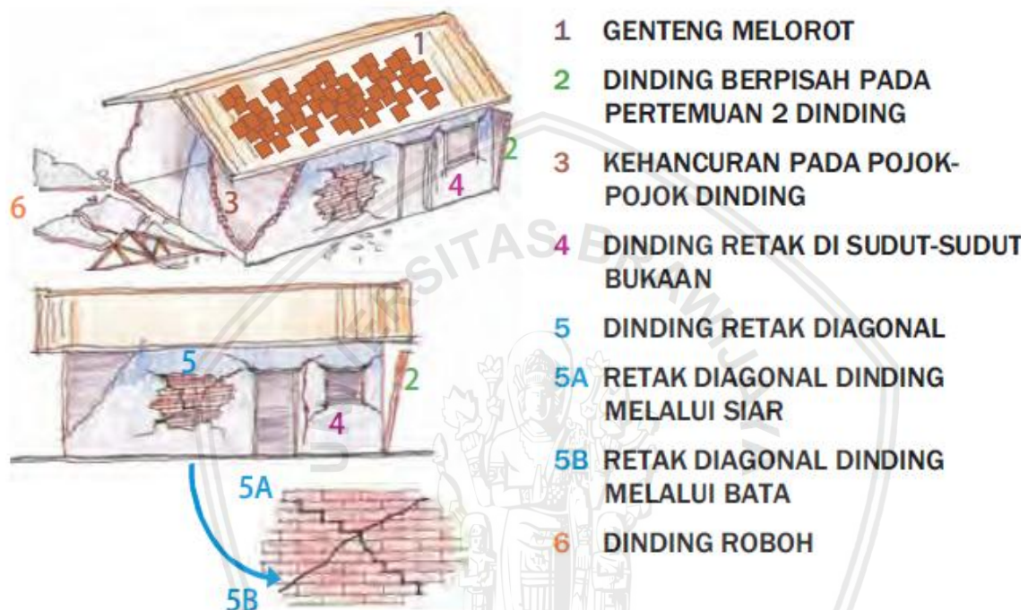
Gambar 2.2 Kerusakan tipikal pada bangunan non-engineered
