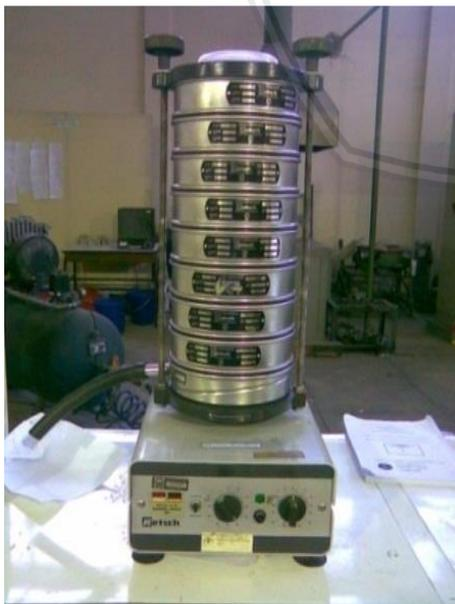
Gambar 3.1 Mesin pengguncang rotap
