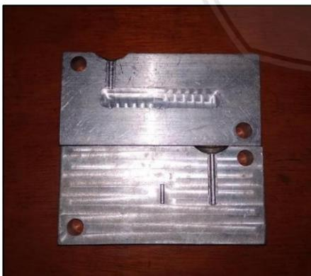
Gambar 3.7 Cetakan spesimen
