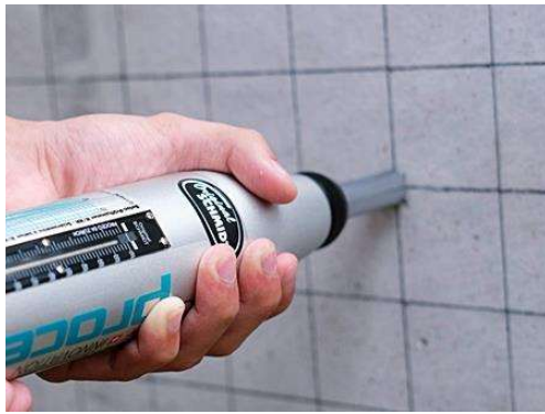
Gambar 5. 1 Hammer Test Yang Digunakan Dan Diagram Konversi Bacaan Pada Alat Terhadap Kuat Tekan Beton
