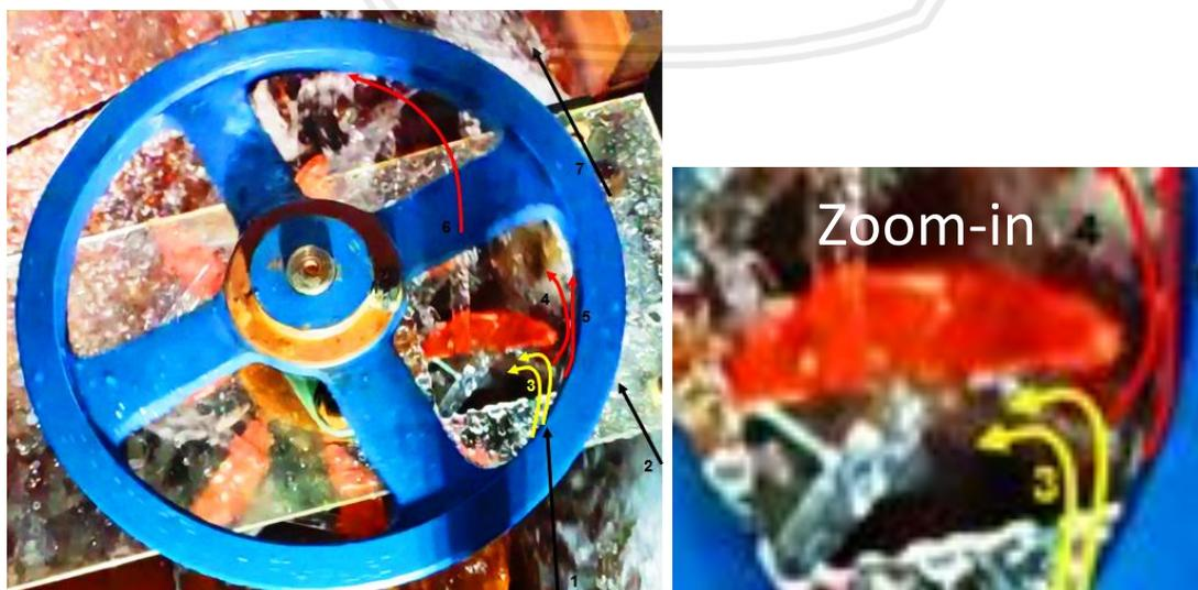
Gambar 5.10 Perilaku aliran dan sudu turbin dengan variasi lebar 10 cm
