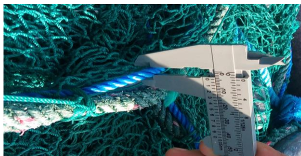
Gambar 12. Tali gantungan kantong bagian bawah pada purse seine di Sendang Biru Malang
