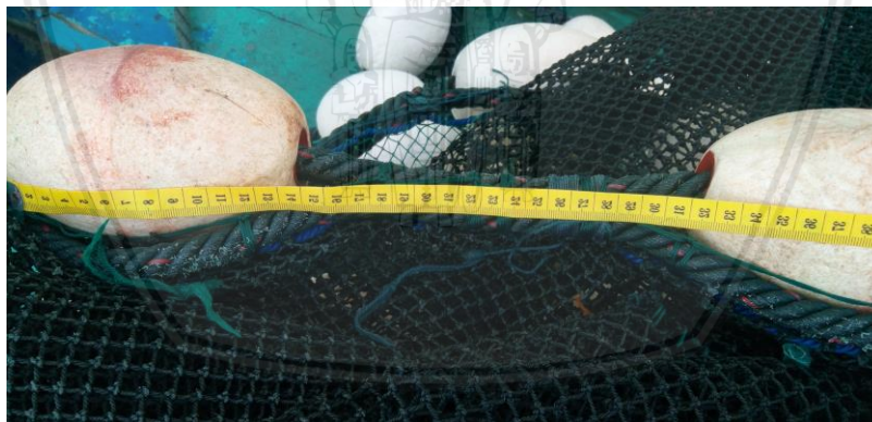
Gambar 13. Jarak Antar Pelampung Sayap pada purse seine di Sendang Biru Malang
