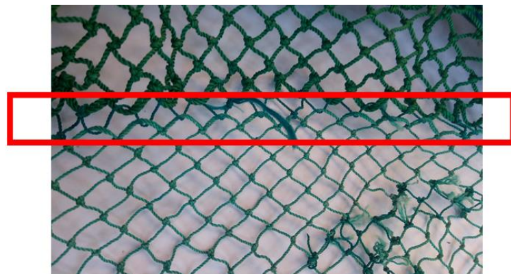
Gambar 10. Penyambungan Webbing dan Salvage Kantong pada purse seine di Sendang Biru Malang
