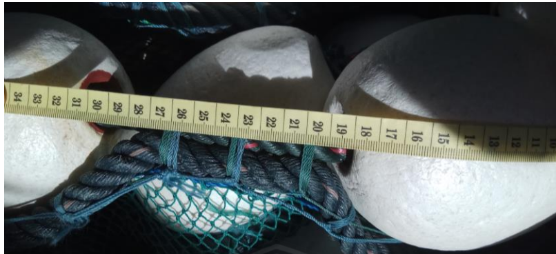
Gambar 14. Jarak Antar Pelampung Kantong pada purse seine di Sendang Biru Malang
