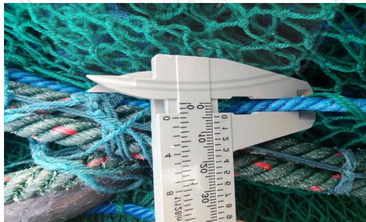
Gambar 7. Tali gantungan sayap bagian bawah pada purse seine di Sendang Biru Malang
