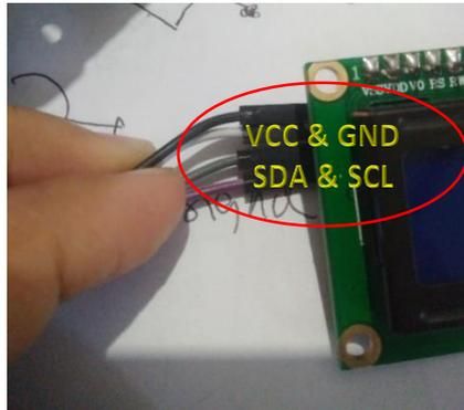
Gambar 3.11 Kabel Data pada LCD
