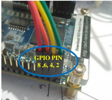
Gambar 3.15 Kabel Data Selektor pada GPIO FPGA
