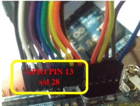
Gambar 3.17 Kabel Data untuk pengiriman 16 bit data hasil cacahan pada FPGA
