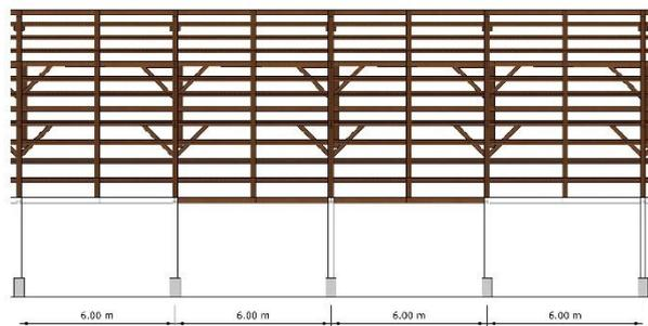
Gambar 4. 34 Jarak antar bagian satu dengan yang lainnya
