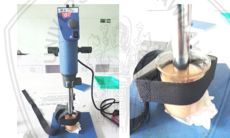
Gambar 5. Proses Pengecilan Ukuran Partikel dengan *Ultra-turrax*
