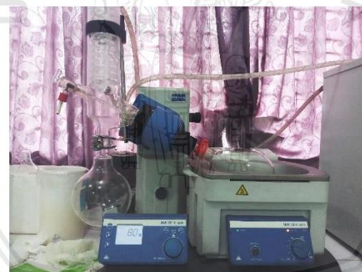
**Gambar 2.** Proses Penguapan Pelarut dengan *Rotary Evaporator*
