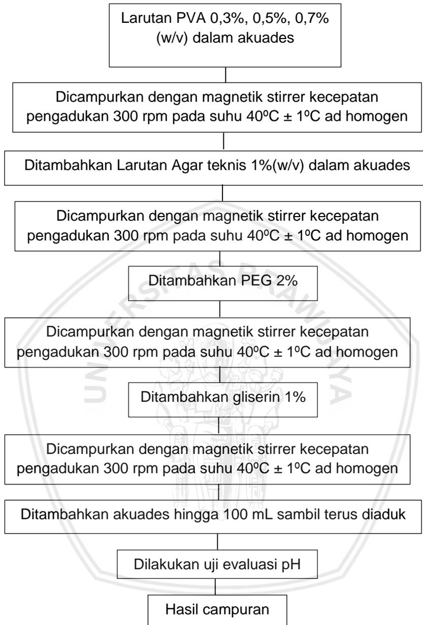
**Gambar 4.3** Kerangka Alur Kerja Optimasi Formula dan Pembuatan Hidrogel dengan Polimer PVA
