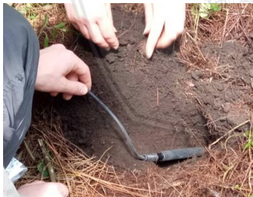
Pemasangan alat sensor suhu tanah
