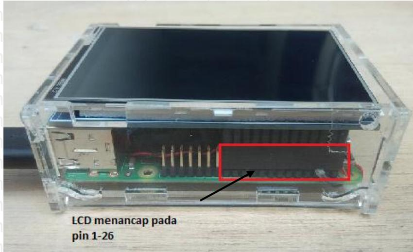
Gambar 5.18 Pemasangan LCD pada *pin* GPIO 1 - 26 Raspberry Pi 3
