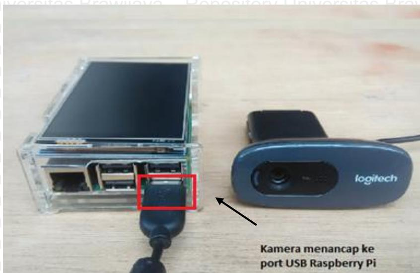
**Gambar 5.17 Pemasangan kamera pada port USB Raspberry Pi 3**
