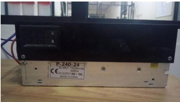
Gambar 3.6 Digital volt dan ampere meter
