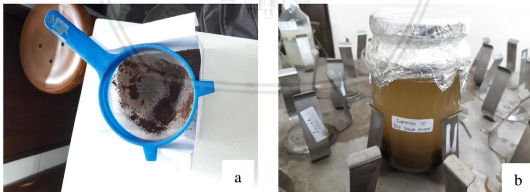
Gambar Lampiran 3.(a) Pengayakan serbuk biji jarak pagar, (b) Proses ekstraksi dengan cara meserasi menggunakan pellarut methanol.
