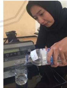
Gambar 10. Pengukuran BOD dengan DO Meter
