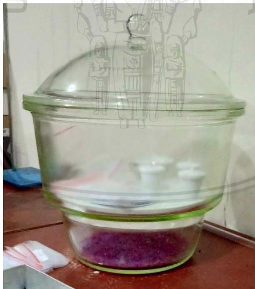
**Gambar B.1.3** Pendinginan kruisibel didalam desikator.
