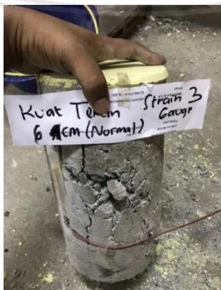
**Gambar 4.5** Hasil Pengujian Kuat Tekan Silinder Beton.
