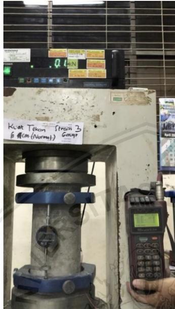
**Gambar 4.4** Proses Pengujian Kuat Tekan Silinder Beton
