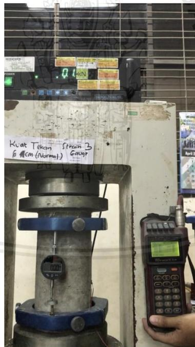
**Gambar 4.10** Proses Pengujian Kuat Tekan Silinder Beton
