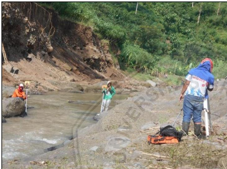
Gambar 3. 5 proses pengukuran situasi sedimen pada sungai
