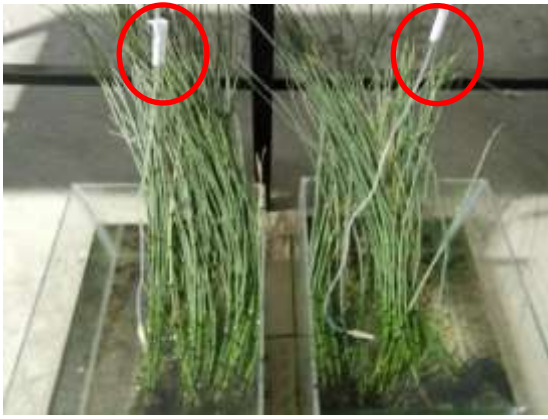
Gambar 4.1 Selang Infus Sebagai Pengatur Kecepatan Aliran
