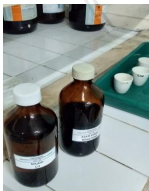
Pemberian Larutan Asam Fenol Disulfonik dan \text{NH}_4\text{OH} 1:1
