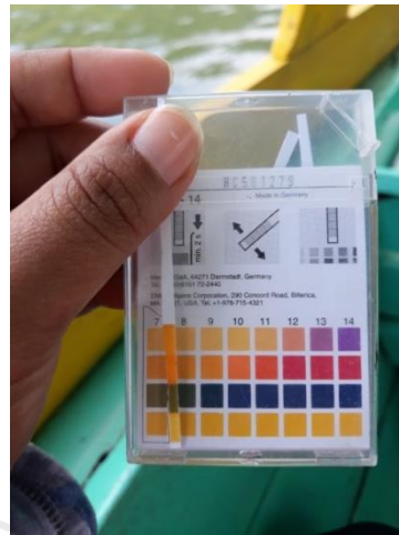
Mencocokkan pH paper dengan kotak standar pH
