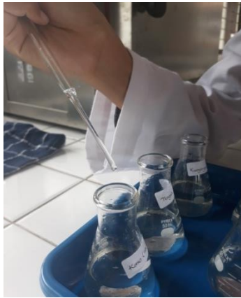
Pemberian Larutan \text{SnCl}_2 dan Ammonium Molybdate
