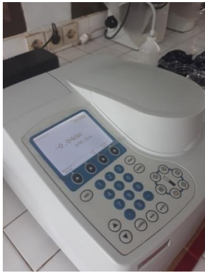
Pengukuran Ortho, Nitrat dan Klorofil dengan Spektrofotometer
