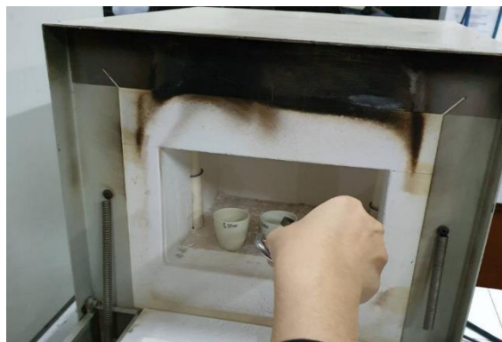
8. Sampel di abukan dalam furnace
