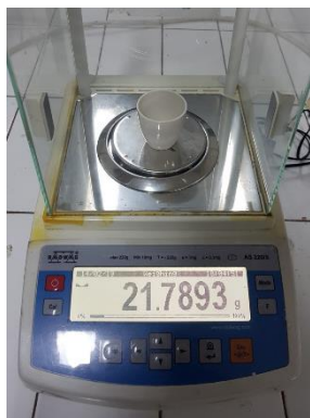
7. Timbang cawan + sampel yang telah di oven sebagai C
