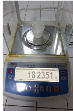
7. Timbang cawan + sampel yang telah di oven sebagai C
