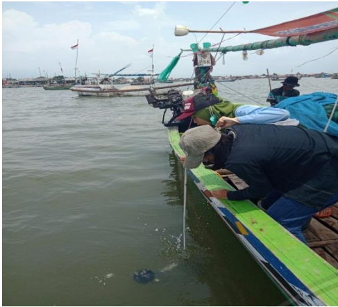
Pengambilan sampel air menggunakan water sampler
