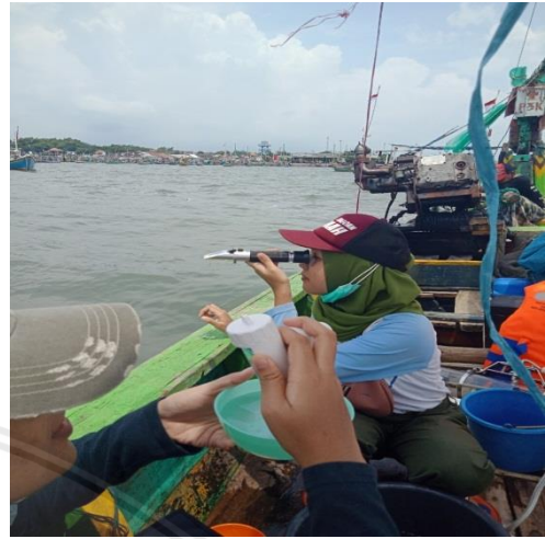
Mengukur salinitas menggunakan refraktometer
