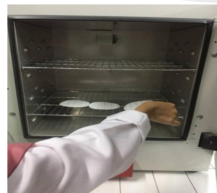
Pengeringan kertas saring pada oven untuk pengukuran TSS
