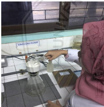
Penyaringan air sampel TSS menggunakan kertas saring yang telah ditimbang menggunakan vacuum pump
