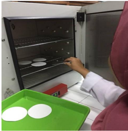
Pengambilan kertas saring yang berada di dalam oven menggunakan penjepit, lalu didinginkan pada desikator
