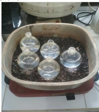
Pemanasan picnometer di atas kompor pemanas sebagai kalibrasi picnometer
