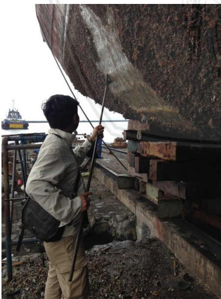
4. Sekrap pada bagian lambung, baling-baling dan kemudi
