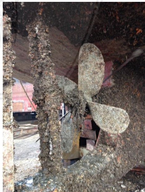
4. Sekrap pada bagian lambung, baling-baling dan kemudi
