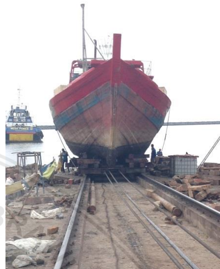
3. Kapal ditarik dengan seling besi menggunakan mesin hawling
